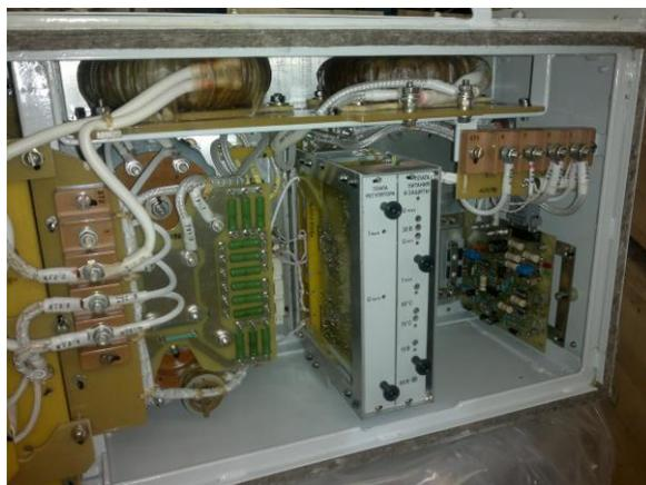
Источник представляет собой статический преобразователь постоянного тока с автоматическим переключением режимов. Высокая точность регулировки и поддержания выходных параметров позволяет выбрать эффективный режим зарядки аккумуляторов и обеспечивает длительный срок их службы.
